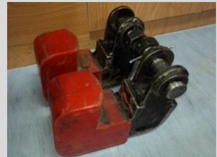
Crochets de levage personnalisés utilisés pour le levage afin de prévenir les dommages.
