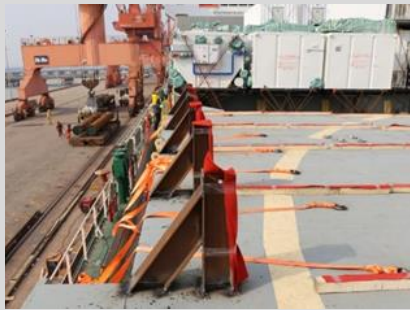
Bouchon avec coussinet sur le bord latéral pour éviter le glissement du tuyau. Coussinet en bois au bas du tuyau pour empêcher le contact direct entre le tuyau peint et la surface dure de l'assise.
