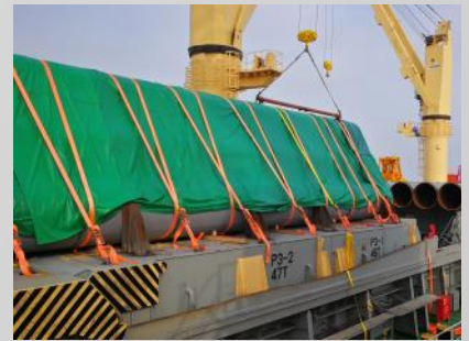
Crochets de levage personnalisés utilisés pour le levage afin de prévenir les dommages.
