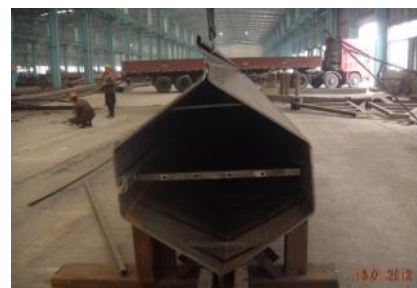
Box King Pilotis (fabriqués sur 2 CRZ pilotis et 1 pilotis formé à froid)
