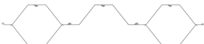
Box King Plotis (fabriqués sur 2 ESC-HRZ Pieux & 1 pieu en U laminé à froid)
